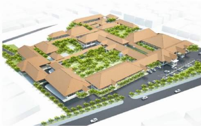
Gambar 4.3. Contoh Pemanfaatan Garis Sempadan Bangunan Sebagai Ruang Parkir
