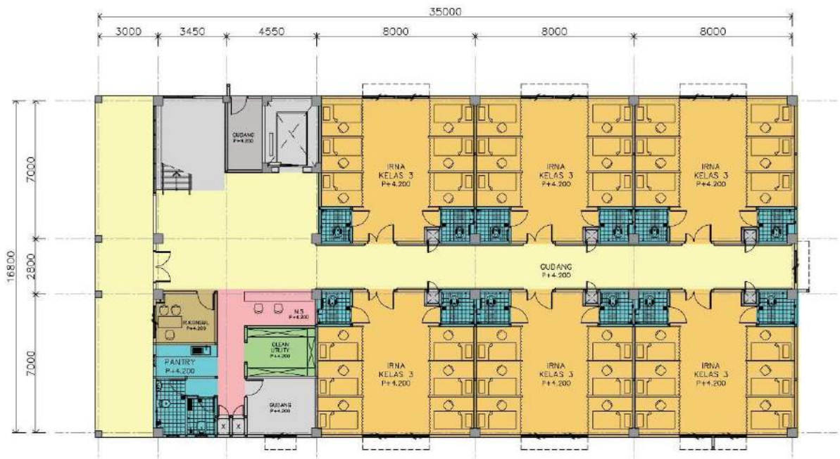
Gambar 5.18. Denah Gedung IRNA lantai 1
